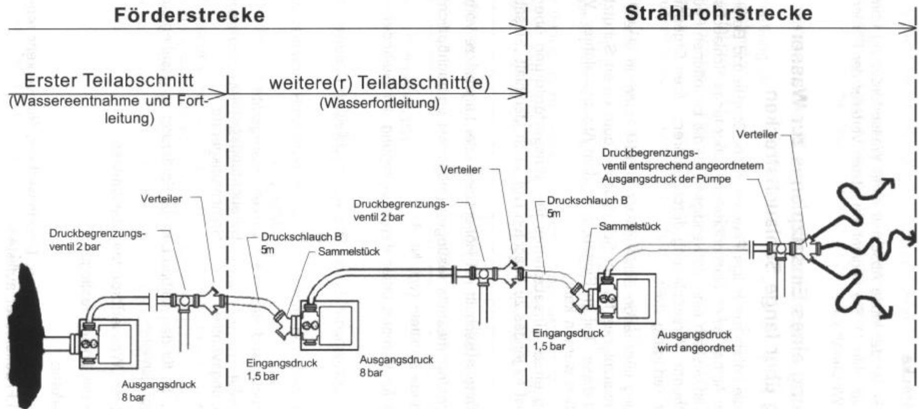
Schaltschema für eine Wasserförderung über lange Schlauchstrecken
